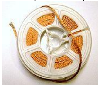
calza desolder wicks + esempio assorbimento stagno
