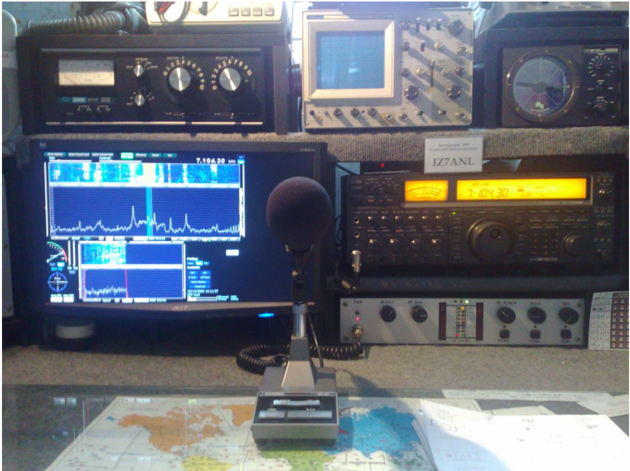
Vista postazione operativa con l'IC775 modificato sulla destra ed il monitor PC relativo al Panoramico-RX SDR
